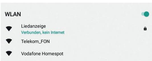
Wenn Sie keine Verbindungsbestätigung erhalten, prüfen Sie bitte, ob die Liedanzeige und der Funk Transmitter korrekt mit einer Stromquelle verbunden sind, bzw ob Sie die dafür vorgesehenen Kabel verwendet haben (Funk – schwarz) Ist dies der Fall, so verringern Sie den Abstand zwischen Funk Transmitter und Tablet (max. 10-15 Meter, je nach baulichen Gegebenheiten, Abschirmungen etc.)
